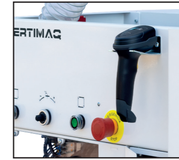
Pistola lectora de códigos de barras para garantizar la carga correcta del programa y reducir errores.
