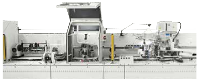
Grupo de encolado para el trabajo de puertas con cantos rechapados bien suaves que rígidos.
