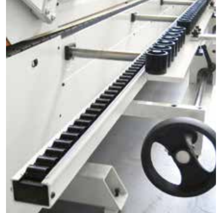
Espalda de contraste para paneles estrechos, macizo o softforming (opcional)
