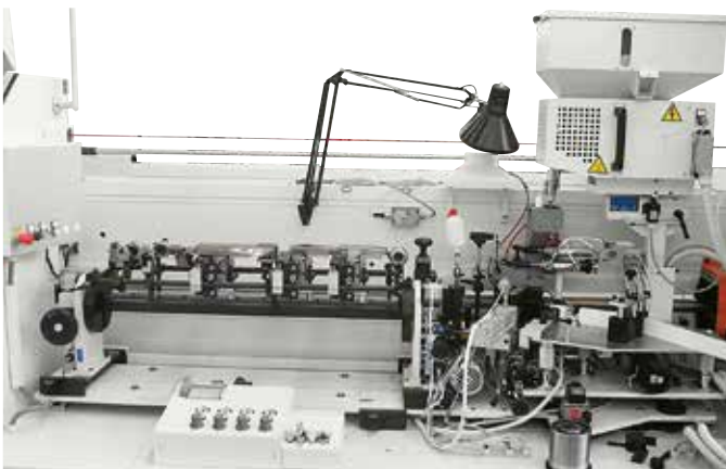
Grupo de encolado para el trabajo de puertas con cantos finos/suaves.
