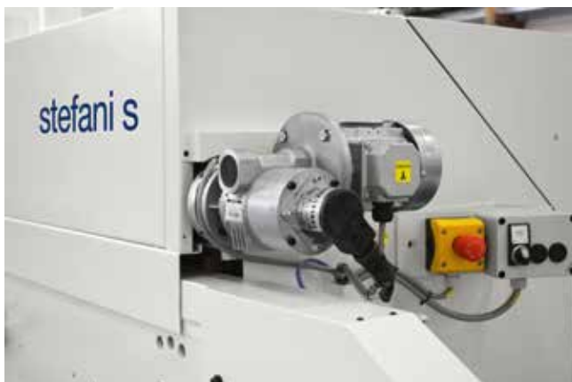
Prensor superior con movimiento desde CN (standard)
