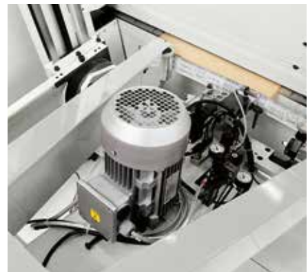
Grupo lijador para tableros perfilados
