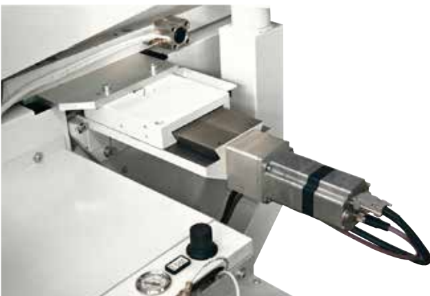
Guia en la entrada manual (standard) pneumatica o con ejes a CN (opcional)
