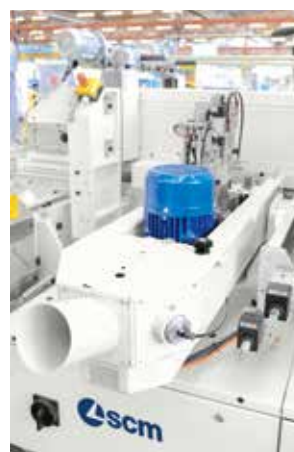
Grupos lijadores para el acabado de la puerta chapeada con canto rechapado.
