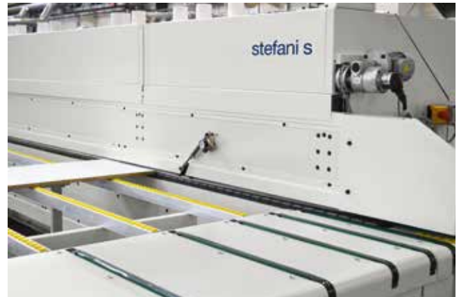
Sistema de introduccion automatica en la entrada de la maquina y transfer en la salida mono / multi correa para la integracion con automatizacion hacia arriba y hacia abajo (opcional)
