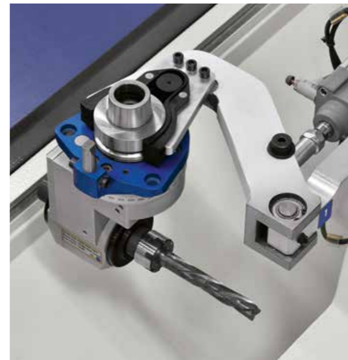
Almacén "Pick-up" de 1 posición fijado al travesaño móvil. Equipamiento ideal para utilizar herramientas y cabezales a reenvío angular de gran tamaño.
