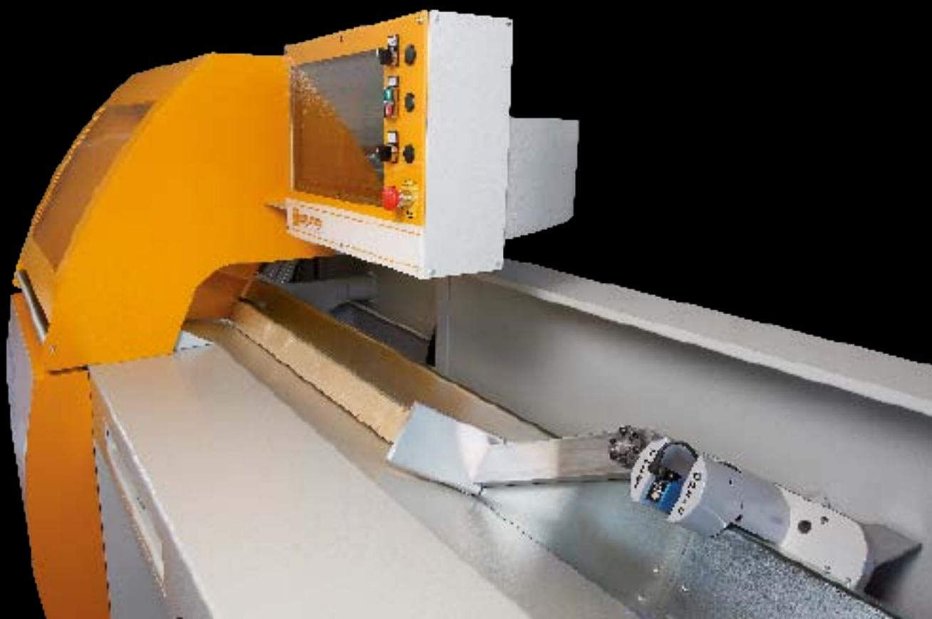
**Extremamente robusto:** trave de deslizamento -suporte de apoio de 135x120 mm revestidos em aço de grossa espessura anti-desgaste, correia de transmissão poderosa dimensionada para cargas até 805 kg.
