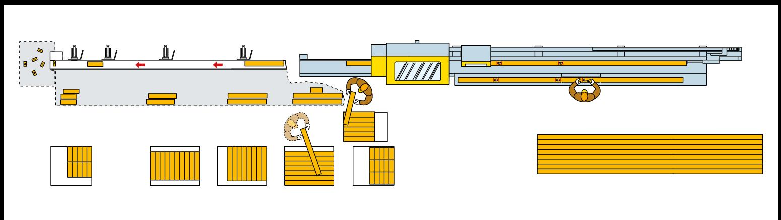
**Extremadamente robusta:** viga de deslizamiento-soporte del empujador de 135x120 mm revestida de acero de gran espesor anti-desgaste, potente correa de arrastre dimensionada para cargas de hasta 805 kg.
